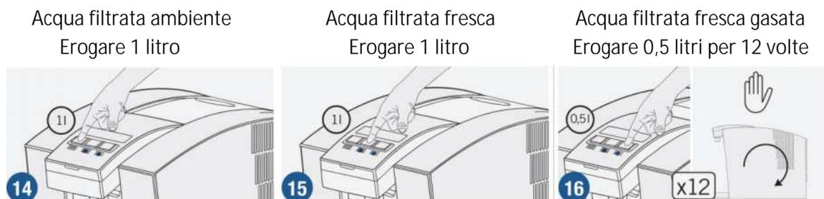
Questa operazione permette al carbonatore di riempirsi e non lasciare all'interno spazi d'aria che potrebbero causare la scarsa effervescenza dell'acqua e la rumorosità eccessiva del GORELLO.
