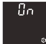
8. Utilizzare i pulsanti UP o DOWN per attivare o disattivare la funzione controlavaggio intensivo.
