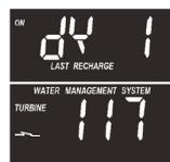
3. Se l'addolcitore è nel mezzo di una rigenerazione, la parte superiore del display indica la posizione della valvola e i minuti rimanenti in tale fase del ciclo di rigenerazione. Il lampeggiare di due posizioni della valvola indica che la valvola si sta spostando da una posizione all'altra.
