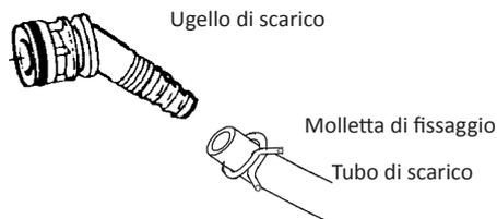
Figura 6 - Installazione del tubo di scarico
